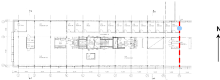
Figur 2. Planritning över plan 3 med utmärkt skiljevägg och kontrollmätningsspunkt av tryckskillnaden över väggen
